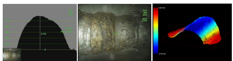
Hiện thị bề mặt quan sát theo mặt cắt biên dạng hoặc dạng Point cloud/ Color map
